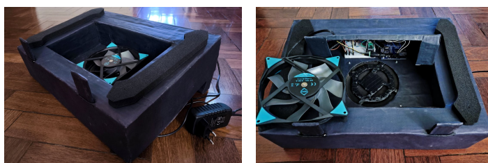
Figura 2. Protótipo da base de refrigeração (MVP) implementado.
